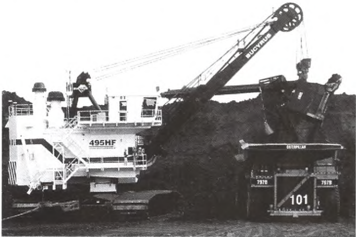
图 2 原比塞洛斯 495HF 型电动挖掘机与卡特 797 型汽车配合装载作业
