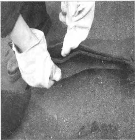
图 4 皮带的老化分层的损耗风险
