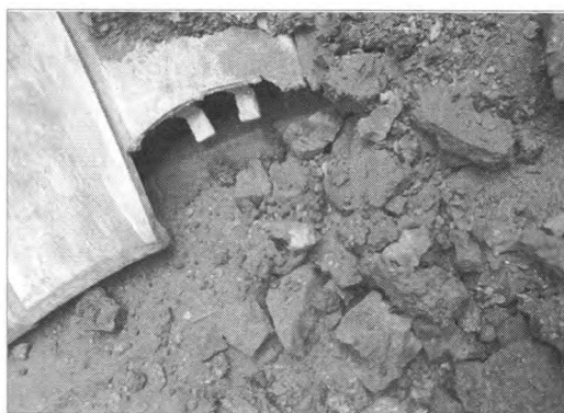
图1 衬板被焦炭冲击断裂而损耗的风险
