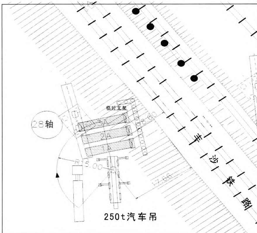
图3 250 t 汽车吊吊装示意图
