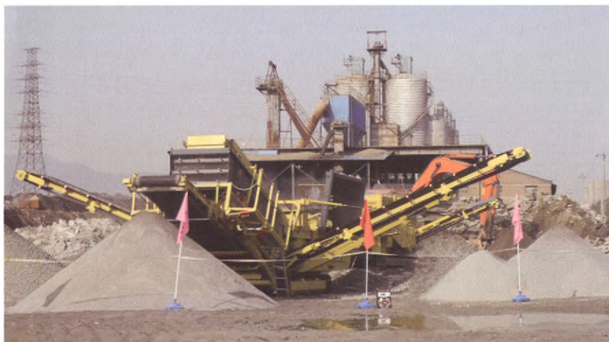
筛分机将不同粒径的粗细骨料分门别类地码放成堆
