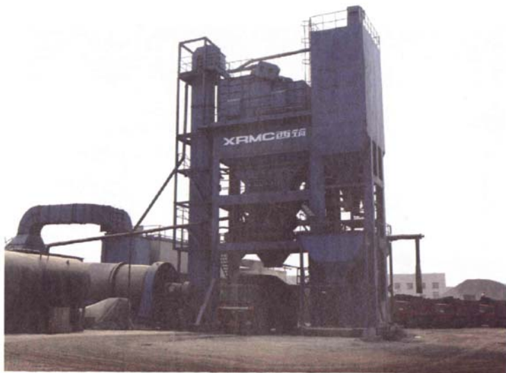
中交西筑J4000型沥青搅拌站承担此次长安街大修近50%的沥青用料
