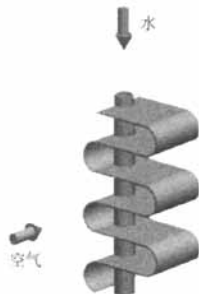
图2 管芯式散热器结构形式
