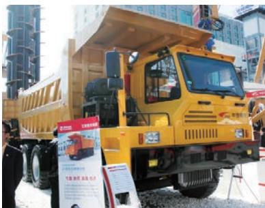
南车展出70吨级自动变速箱宽体矿用自卸车宽体矿用自卸车在国内出现并得到迅猛发展
