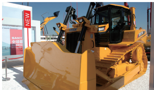
三一推出采用独特的负载敏感液压控制系统的液压推土机SYT70
