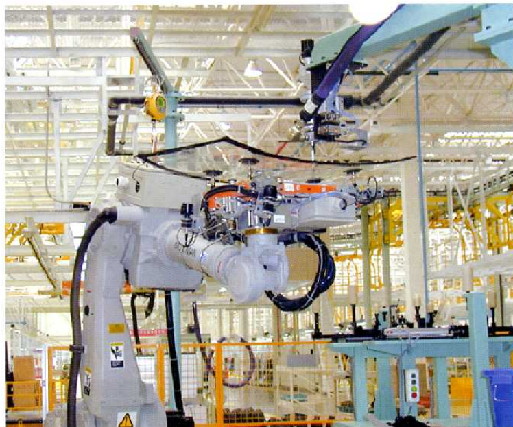
图5 SGM为湖南长丰汽车制造有限公司设计制造的机器人涂胶
