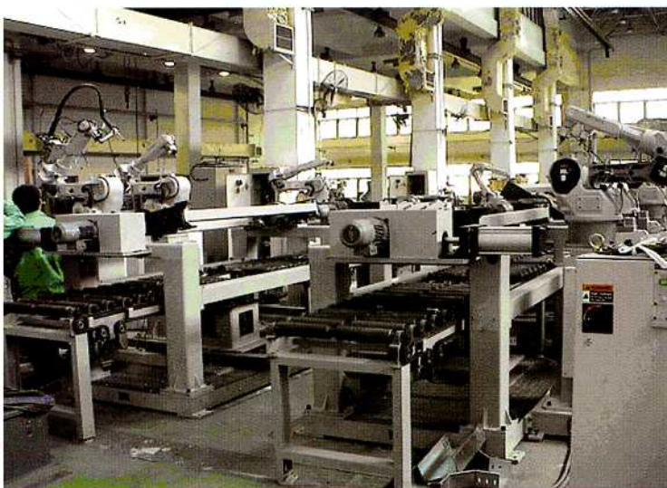
图1 首钢莫托曼设计制造的国内第一条重型车桥焊装生产线(包含14台机器人)
