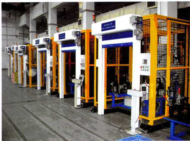
图2 首钢莫托曼为某企业设计制造的轻型车桥焊装生产线(包含12台机器人)
