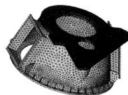
图 2 齿轮箱箱体有限元模型
