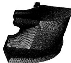
图 4 旋转圆筒 1/4 有限元模型
