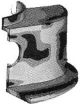
图 7 旋转圆筒热机耦合分析等效应力分布
