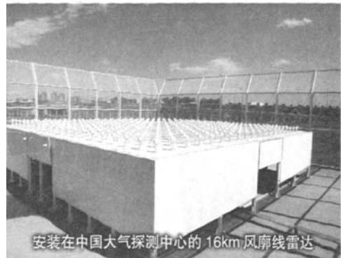
安装在中国大气探测中心的16km风廓线雷达
