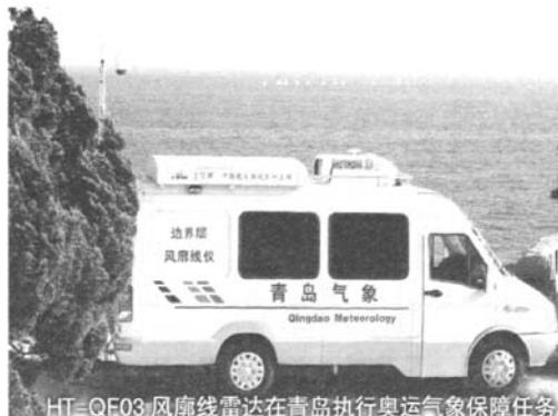
北京无线电测量研究所研制的8000m对流层风廓线雷达采用固态有源相控阵技术,能够不间断地探测相应高度范围内的大气水平风场、垂直气流、大气虚温以及大气折射率结构常数等气象要素随高度的分布。该产品在高新技术开发应用、探测性能、结构设计和产品
