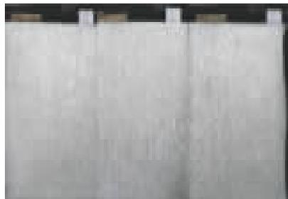
图 1 首秦 X80 管线钢铸坯的低倍照片
