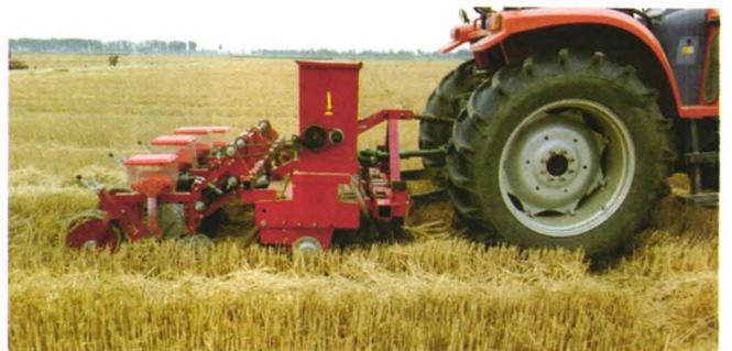
图3 深松全层施肥后置种带旋耕玉米免耕精量播种机田间试验
