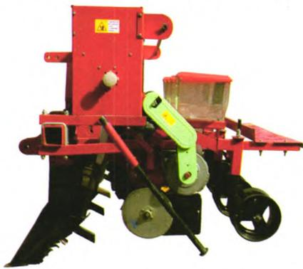
图1 玉米免耕深松全层施肥精量播种机
