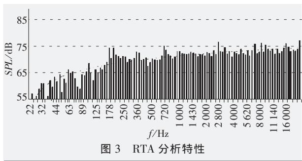
图 3 表明,该馆的声频频率响应特性非常优良。很适合篮球比赛使用,并且能够达到 GYJ25—86“厅堂扩声系统声学特性指标”标准中音乐扩声系统一级要求。
