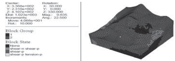
图6 整体塑性区云图
