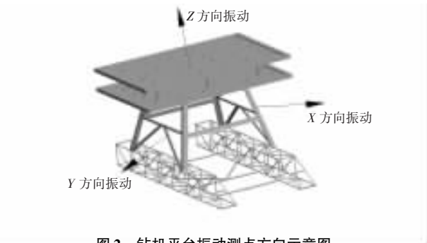
图 2 钻机平台振动测点方向示意图
