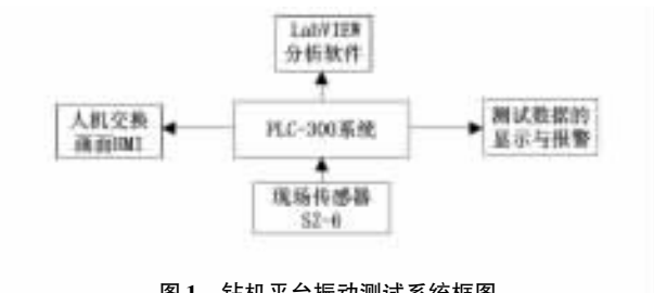
图 1 钻机平台振动测试系统框图
