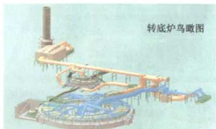
图 MCCE转底炉法直接还原铁工程的三维设计方案图
