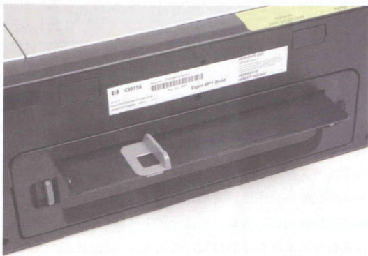
图3 K8600特别设计的后进纸槽为特种纸打印提供了方便
