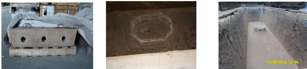
图 6 中间包内部结构
