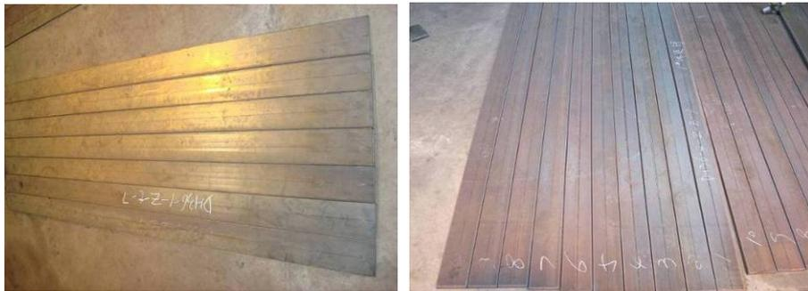
图 9 部分开平船板采用等离子切割后的板条照片
