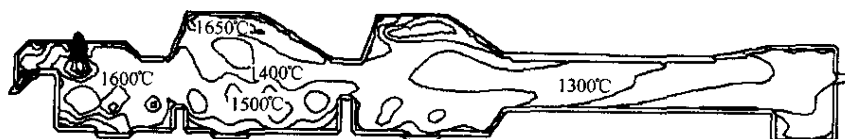
图 1 原加热炉温度场分布
