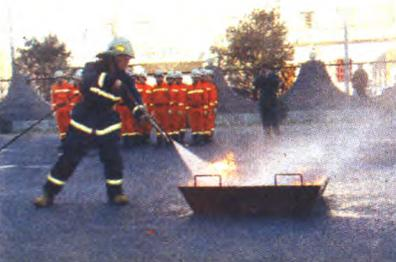
进技术,工作压力高达20兆帕,超细雾滴颗粒DV1.99只有65微米,欧美国家70%以上的消防车都装备了该高压细水雾灭火装备。该装备可一机多用,可扑救多种类火灾,同时可以实现扑救1000
